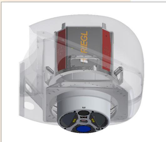
Система RIEGL VQ-1560 II-S установлена в носовом обтекателе самолёта DA42 MPP
