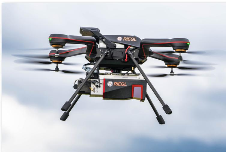
Лазерный сканер RIEGL VUX-100<sup>25</sup> с полностью интегрированным блоком ИНС/ГНСС RiLOC-F установлен на беспилотную платформу Ascotech Zoe
